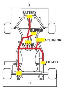
3) Vous pouvez couper puis isoler avec du ruban isolant les parties de câble non utilisées pour le karting en vous référant aux détails du diagramme électrique ci-joint (EFFECTUER CETTE
